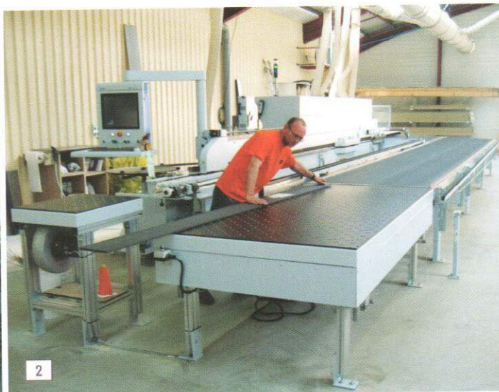
[1] Le nouveau centre d'usinage BAZ de chez Homag. [2] La plaqueuse de chants Homag fait partie des 850.000 euros d'investissements dans le parc machines de Fidelem.
